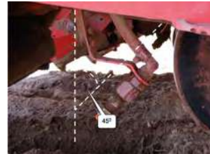
Правильна установка розпилювача — 45–55 градусів від вертикалі
